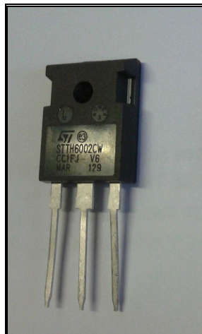
Figura1 – Due diodi STTH6002C: uno dei due è originale, l'altro è contraffatto.
